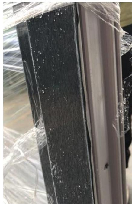
Отслоение ламинации с торца – реставрация, подклейка
